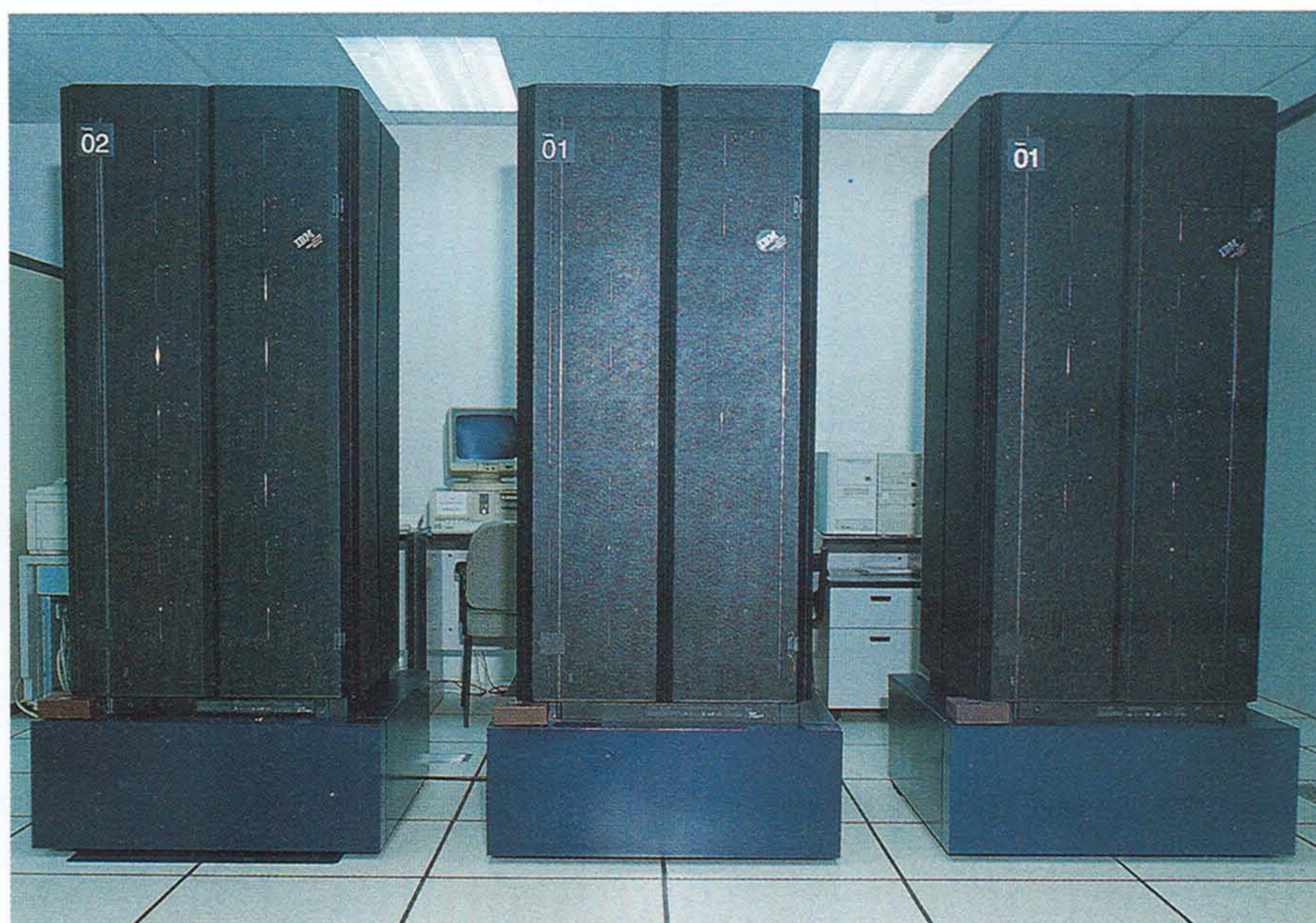
L'IBM SP2 amb 44 processadors té una potència punta de 11,72 Gflops/s i ocupa el rànquing 210 entre les màquines més potents del món.
